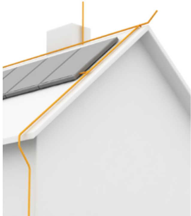
Direkter Anschluss der PV-Montagegestelle an das Blitzschutzsystem
